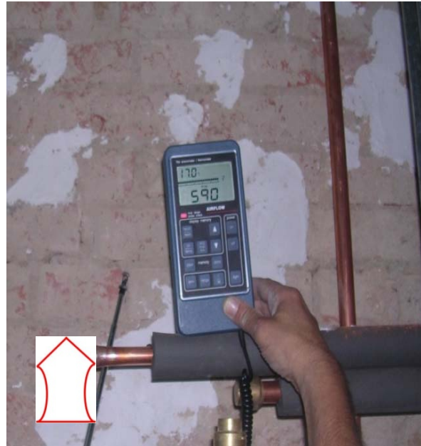
BlowerDoor Test bei Unterdruck
