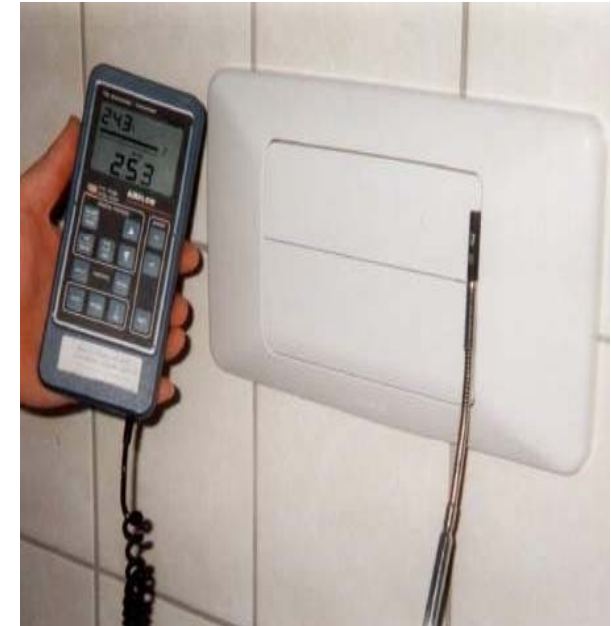
BlowerDoor Schlussmessung nach DIN EN 13829 oder ISO 9972
