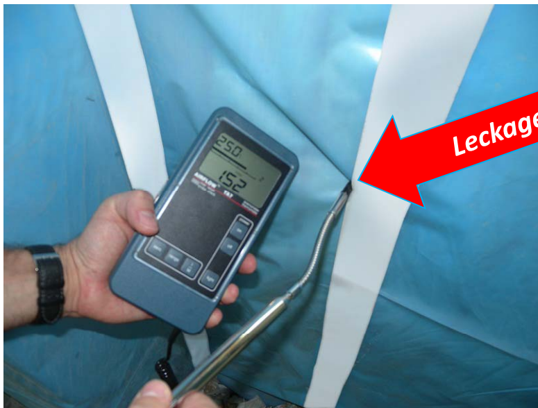
Leckageortung mit Luftgeschwindigkeitsmessgerät
