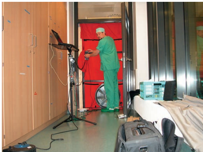
Bild 3. Prüfung der Luftdichtheit eines OP-Raumes in einem Krankenhaus (Fotos: BlowerDoor)
