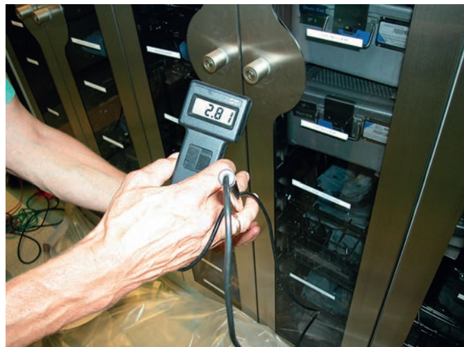
Bild 2. Anzeige der Luftgeschwindigkeit an einer Undichtheit
