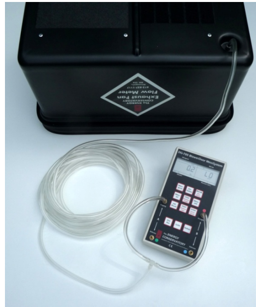
Abb. 5: LuftstromBox mit angeschlossenem DG-700
