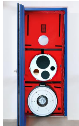
Abb. 3.2: Eingebaute Field Check Blende und Messgebläse BlowerDoor Standard
