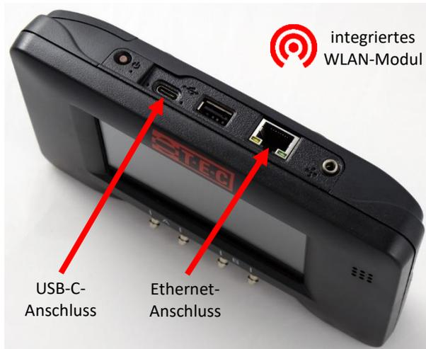
Abb. 2.4: DG-1000 Kommunikationsschnittstellen
