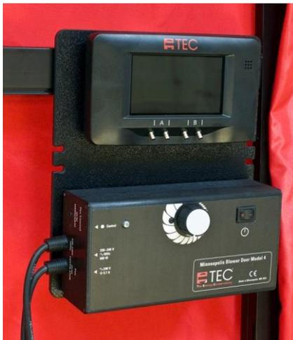
Der Drehzahlregler des Gebläses wird zusammen mit dem DG-1000 an die obere Innenstrebe gehängt.
