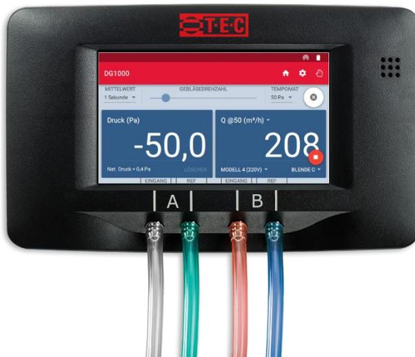
Treten während der Messung Luftturbulenzen am Messgerät aufgrund ungünstiger Einbausituationen (z. B. enger Flur) auf, kann zusätzlich auf Kanal A (EINGANG) ein Stück Schlauch angebracht werden. Das Ende dieses Schlauches wird so platziert, dass es nicht im Strömungsbereich des Gebläses liegt (z. B. in einem anderen Raum).
