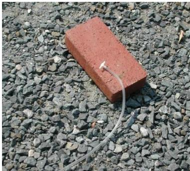
Der transparente 10 m-Schlauch wird bei der Messung des Außendrucks für die Gebäudedruckdifferenz (Referenzdruckmessstelle) verwendet. Das eine Ende wird von außen an den grün markierten Anschluss der Plane gesteckt, das andere Ende wird ca. **10 m vom Gebäude entfernt platziert** und mit einem Schlauchverbinder T (T-Stück) versehen.
