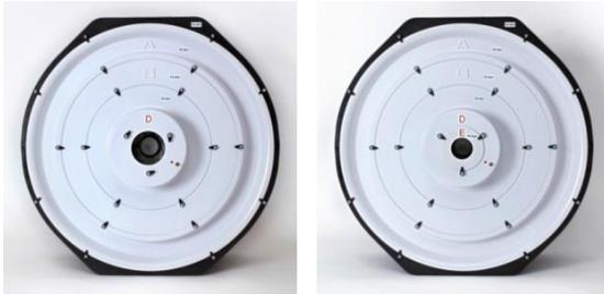
Blende D wird mit sichtbarer Blendenbeschriftung in Blende B gesetzt (nach Herausnehmen von Blende C). Für die Messung mit Blende D oder E wird der rote Schlauch für die Volumenstrommessung (Gebläsedruck) an Blende D angeschlossen.
