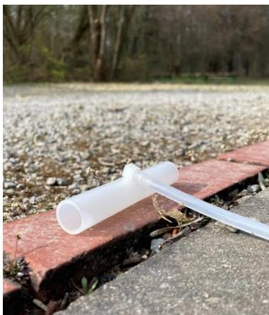
Dieses Ende darf nicht im Ausströmbereich bzw. im Luftstrom des Messgebläses liegen, da es dort zu Verwirbelungen kommt. Auch bei Wind wird das Schlauchende soweit wie möglich vom Haus bzw. von Hindernissen entfernt platziert, um den Außendruck in einem ungestörten Bereich messen zu können. Sinnvoll ist die Verlegung auf der windabgewandten Seite. Bei Sonneneinstrahlung den Schlauch waagrecht verlegen, um thermische Strömung im Schlauch zu verhindern.
