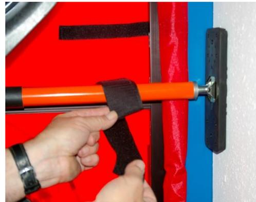
Abb. 5.5: Kurze Strebe zur horizontalen Befestigung
