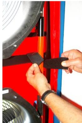
Abb. 5.4: Lange Strebe zur vertikalen Befestigung
