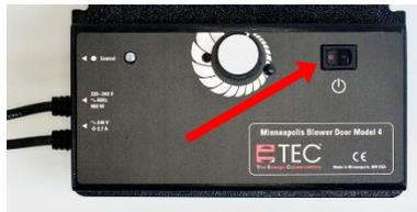
Abb. 7.70: Drehzahlregler
