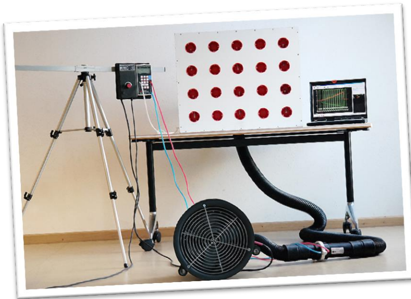
Bauteilprüfung mit dem Micro Leakage Meter (MLM)
