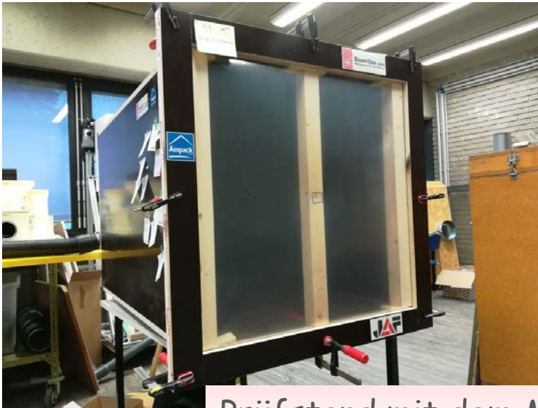
Prüfstand mit dem Micro Leakage Meter zur Messung von Einzelleckagen
